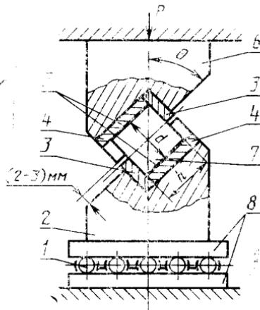
1 — роликовая постель; 2 — нижняя матрица; 3 — вкладыш; 4 — обоймы; 5 — фольга; 6 — верхняя матрица; 7 — образец; 8 — плиты
