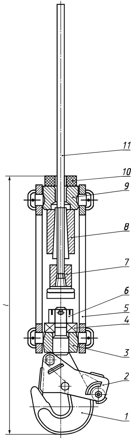
1 — крюк; 2 — защелка; 3 — нижняя траверса; 4 — упорный подшипник; 5 — щеки; 6 — гайка; 7 — клиновидная муфта; 8 — цанговая втулка; 9 — верхняя траверса; 10 — амортизатор; 11 — подъемный канат
