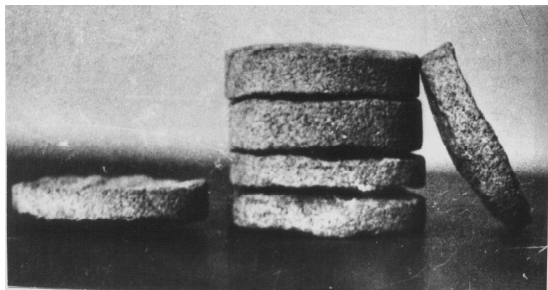
Рис. 9. Форма «дисков», образованных при бурении керновых скважин в опасной по выбросам зоне в выбросоопасном слое песчаника.
