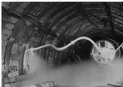
Рис. 20. Общий вид оборудования для охлаждения горного массива жидким азотом.
